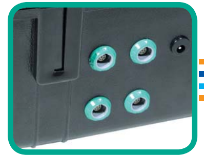
多达4个传感器输入，电源可供所有传感器
